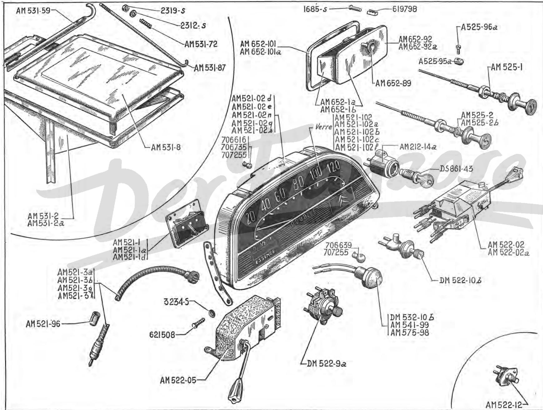
106 — TABLEAU DE BORD 6 VOLTS - BATTERIE - COMMUTATEURS - TIRETTES - AM - AMB
