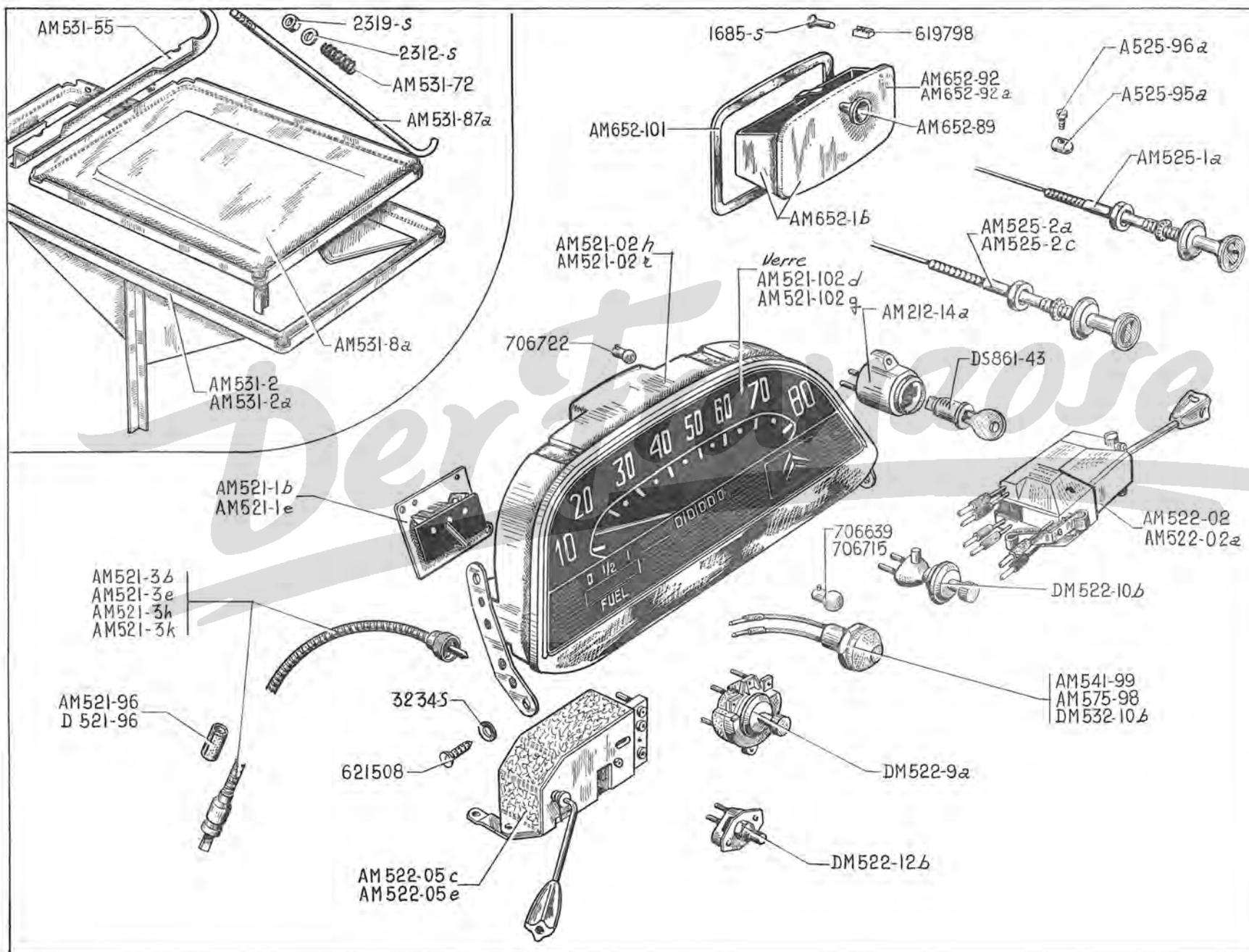
110 — TABLEAU DE BORD 6 VOLTS - BATTERIE - TIRETTES - COMMUTATEURS - AK
